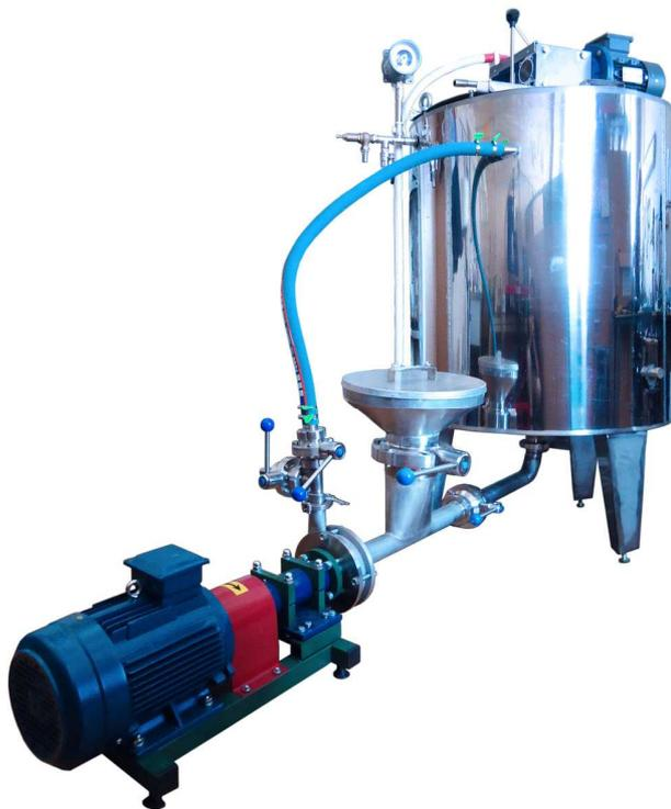
Реактор имеет пароводяную рубашку с блоком электронагревательных элементов и мешалкой рамного типа с электроприводом.
