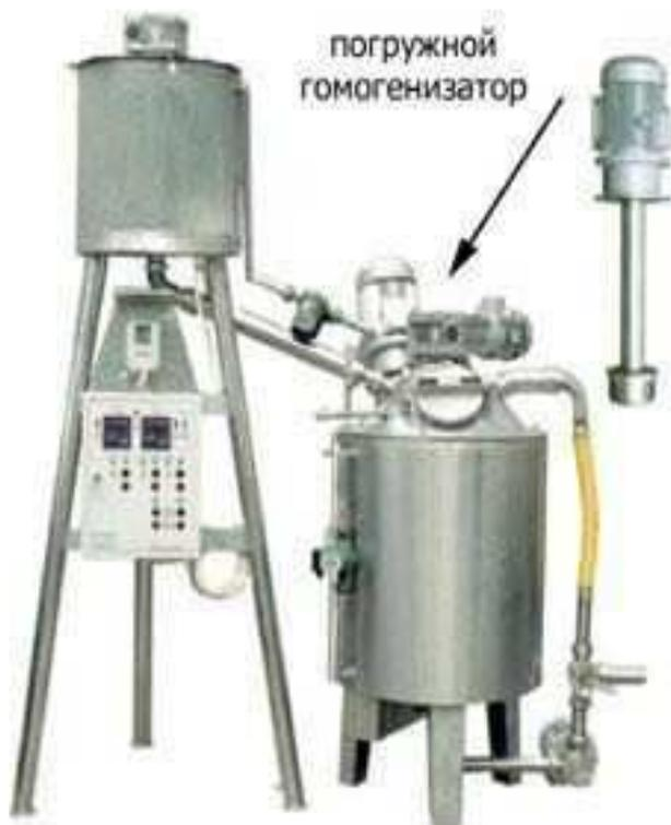
Систему поддержания температуры ( $20^\circ\text{C}$  гистерезис  $\pm 5^\circ\text{C}$ ) в тепловой рубашке, и датчик для измерения температуры внутри теплового воздухоудалителя, с индикацией на пульт управления. Обогреваемая труба подачи сапропеля в реактор, мерная трубка уровня теплоносителя. Моющая головка.
