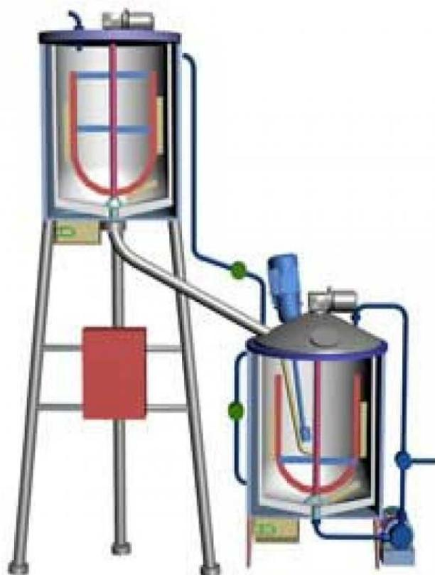
**Устройство.** Реактор; тепловой воздухоудалитель и; насос для перекачивания вязких продуктов; насос подачи «плавленого» сырья; пульт управления; трубопроводная арматура, циркуляционные насосы.
