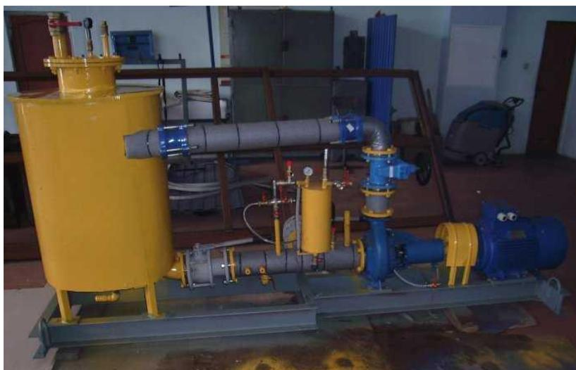
Общий вид диспергатора-гомогенизатора КИП-1,0 при производстве гуматов калия и натрия (образец на 500 л)
